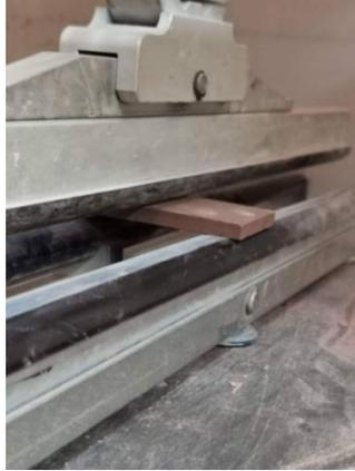
شكل 6 يوضح أحد عينات البلاط السيراميكي أثناء إجراء الاختبار
