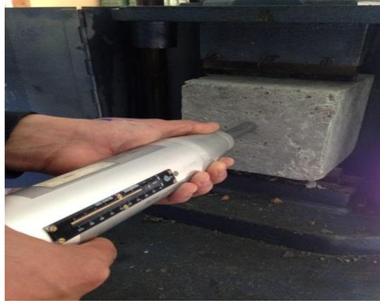
الشكل 4: طريقة إجراء اختبار مطرقة شميدت.
