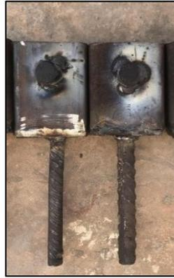
الشكل 7 الأداة التي تسمح بتثبيت العينة في جهاز الإختبار
